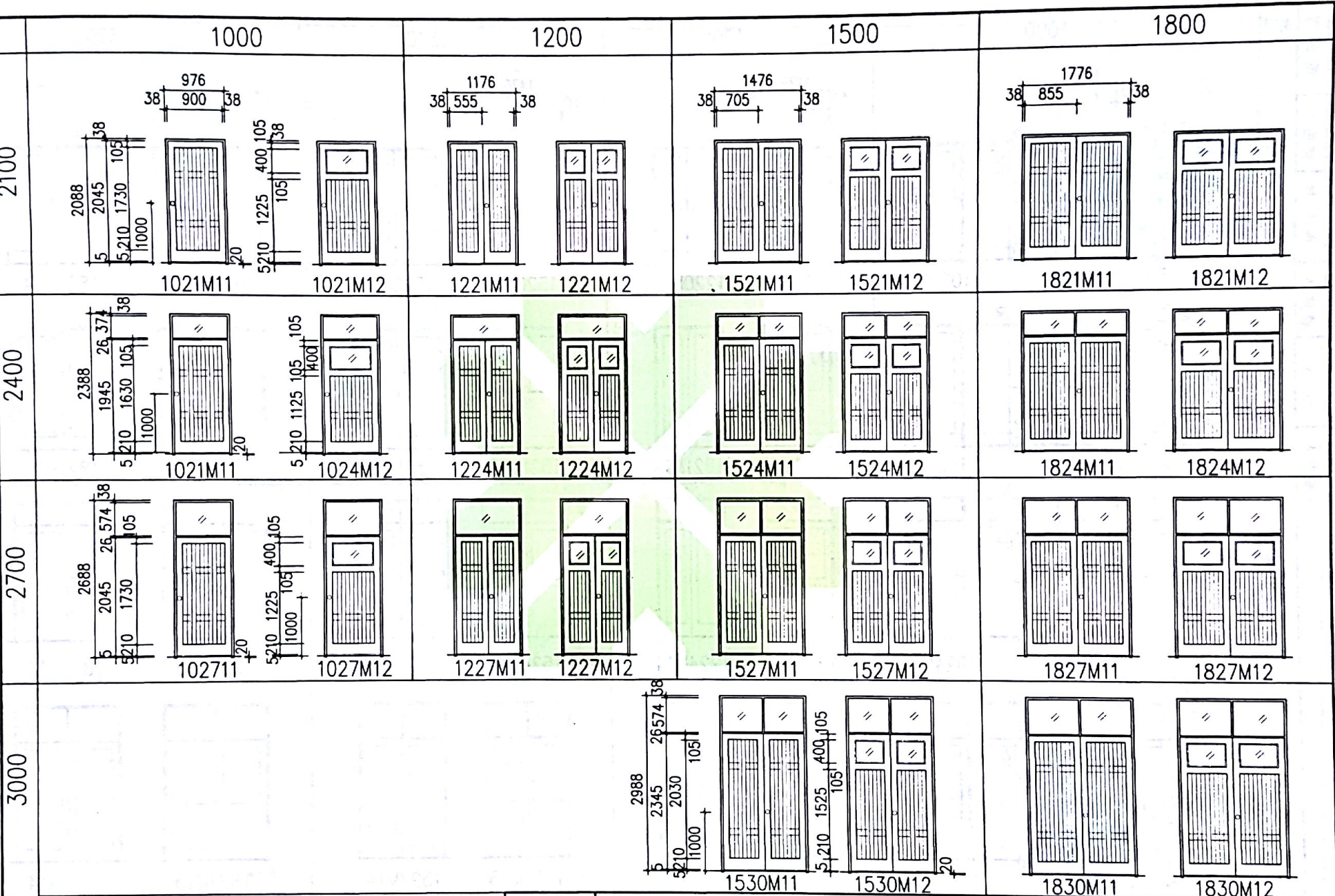
图 名 实木拼板及拼板小玻门 M11, M12 加工尺寸图 图集号 12BJ13-3 页次 A19
